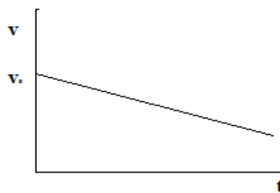
зависност брзине од времена код равномерно успореног кретања a < 0
